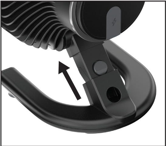
2. Om de voet opnieuw te installeren schuift u deze op de stang van de ventilatorkop, over de knop, totdat hij vastklikt.
